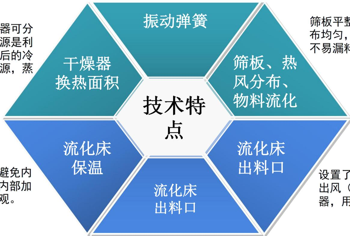
采取全封闭焊接，避免内部保温材料潮湿与内部加强筋腐蚀，外表美观。
